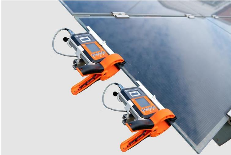
1 Koppeln Sie Temperatur- und Sonnenlichtmessgeräte mit dem Gerät.
